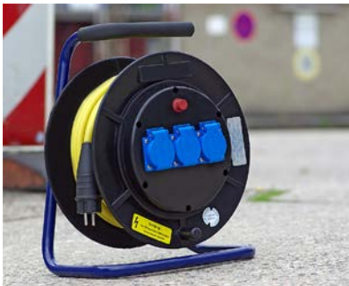
Abb. 20 Geeigneter Leitungsroller und Typschild mit notwendigen Angaben
